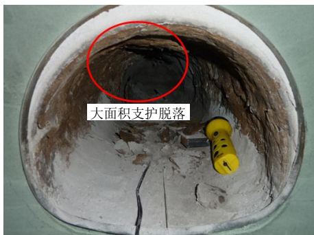
(d) Z = 0~50 cm 范围支护大面积破坏、脱落
