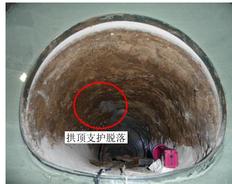
(c) Z=0~50 cm 范围局部拱顶支护开裂、脱落 Z=100~150 cm 范围围岩大面积破坏
