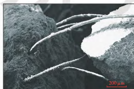
(b) 长纤维桥联裂纹
