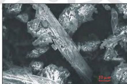
(a) 微纤维阻止微裂纹扩展
