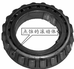
图1 滚动体点蚀的 7216 轴承
