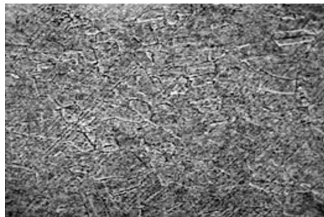
图17 凹坑中部和内底面均无滑移带,内层出现较多孪晶
