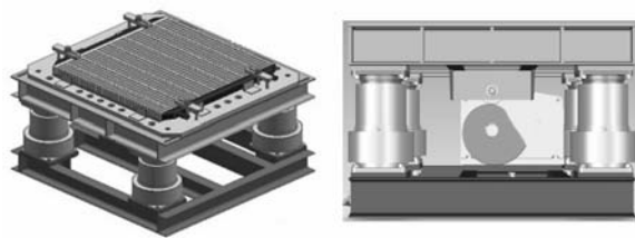
图 1 散热器振动试验台
