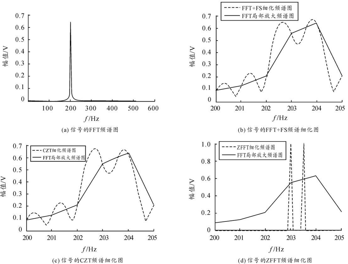
图3 基带 FFT、FFT-FS、CZT 和 ZFFT 的分析对比
