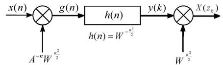
图 1 CZT 的计算流程
