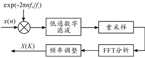
图2 ZFFT的计算流程
