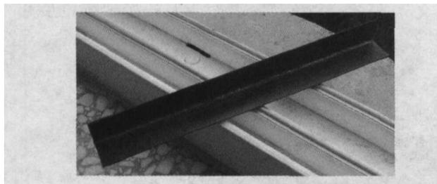
图 6 二次成型制备的“L”型加强筋
