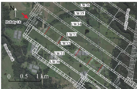
图 1 West Cliff 煤矿工作面布置
