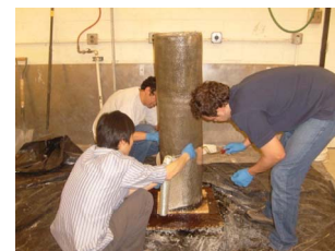
(e) FRP wrapping
