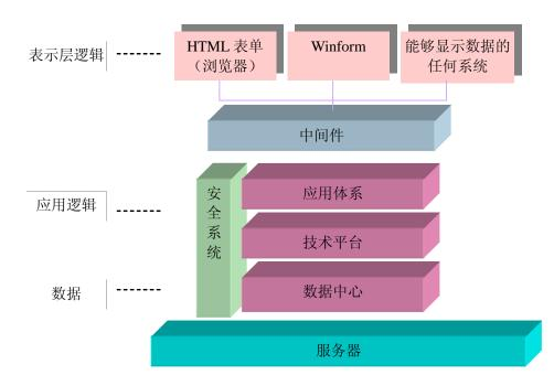
系统架构平台是在. NET 框架和 XML、WEB Service 的基础上,利用三层体系结构设计和规范的应用系统,由图可见,整个应用划分为三个相对分离的逻辑层,每一层都有一套定义好的接口。第一层为表示层,是展现给工作人员和相关使用者的图形界面,它包含 HTML 表单等能够显示数据的任何系统。该界面通过规定的工作流程和接口来完成日常的事物处理和业务流程。
