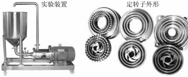
图1 高剪切均质泵实验装置与定转子外形
