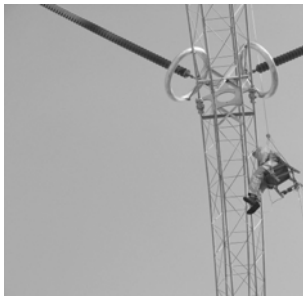
图5 模拟人与导线等电位接触时流过屏蔽服电流的测量布置照片
