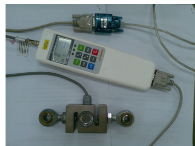
图 8 山度 SH-5kN 数显式推拉力计 Fig.8 SH-5kN digital force gauge
