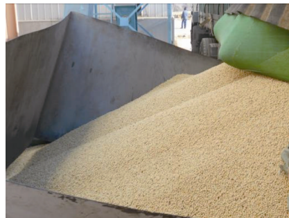
图 3 TD250 型斗式提升机进料过程
