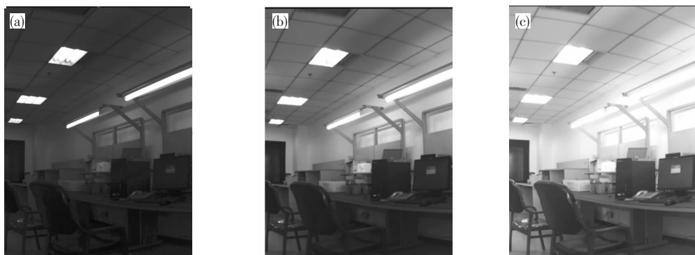
图 1 曝光时间不同的图像。(a)曝光时间为 100T ,能清晰看清灯管的轮廓,但丢失低亮度细节信息;(b)适度曝光图像,曝光时间为 300T ;(c)曝光时间为 500T ,实验桌上的物品清晰可见,但灯管轮廓细节丢失。
