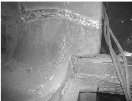
图 14 修复后的刀孔
