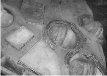
图 13 修复后的刀盘面板
