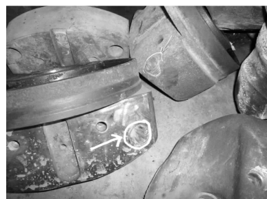
(e) 刀具安装螺栓断
