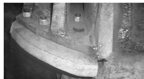
图 12 加固后的刮刀座
