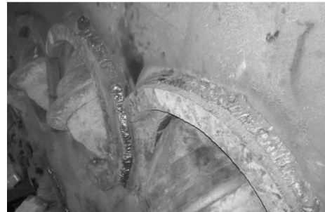
图 16 加固后的刀孔护圈
