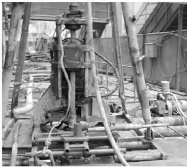
图2 施工钢管桩的钻机
