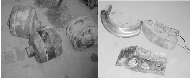
图3 变形及破坏的滚刀刀具
