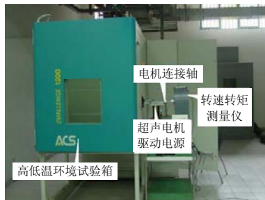
图1 高温环境试验装置系统 Fig. 1 Testing system under the high temperature condition
