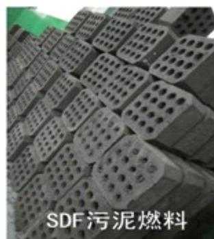
SDF 污泥合成独立燃料技术是主要以城市污水处理厂脱水后含水率 80%的污泥为主要原料，并辅以添加剂，经过无害反应（消毒、除臭、重金属钝化等）、半干化、成型等工艺流程，得到各理化指标与优质煤相当的独立燃料。
