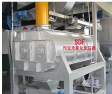
GDS 热风重力干化机系统：经过无害化处理后的污泥进入 GDS 污泥热风重力干化系统，污泥在中低温干化系统过程中病原微生物得到进一步杀灭，同时干化过程中伴随水蒸气产生的恶臭气体通过负压收集至气体净化系统进行处理，处理后气体可达标排放。
