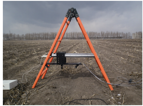
图 4 地表粗糙度测试仪野外试验现场 Fig.4 Surface roughness tester at field test site
