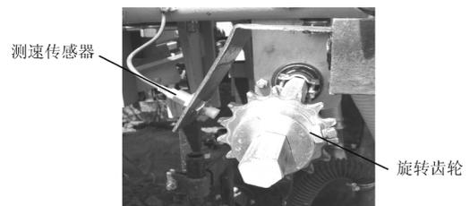
图 4 速度传感器安装图
