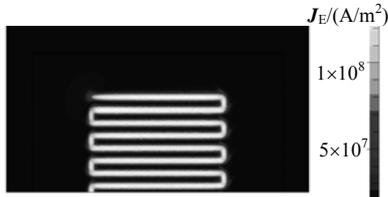
图 4 铝板表面涡流密度分布云图
