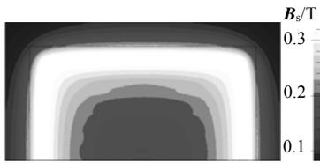
图 5 铝板表面磁感应强度分布云图
