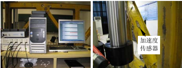
图 9 动态测试系统及整体损伤监测
