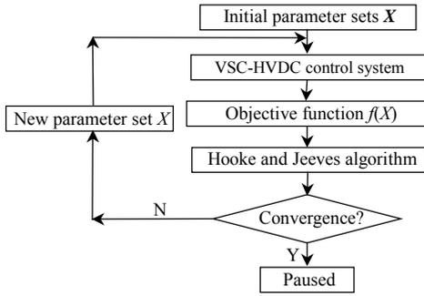
图6 VSC-HVDC 控制系统参数优化流程图
