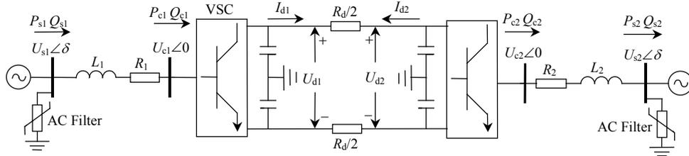
图3 两端 VSC-HVDC 系统图
