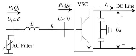
图1 VSC-HVDC 的稳态模型
