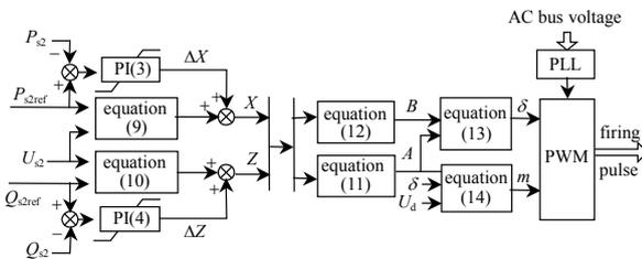
图4 定功率控制系统图
