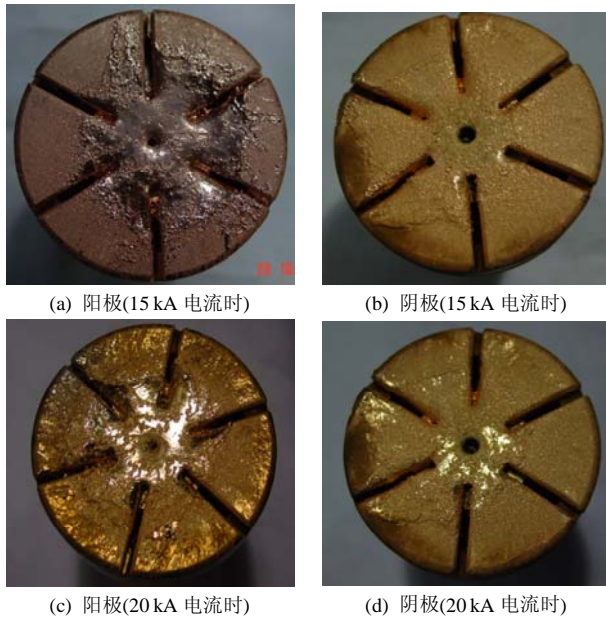
图 9 电极间距 16 mm, 电流分别为 15 和 20 kA 的电弧烧蚀后的电极
