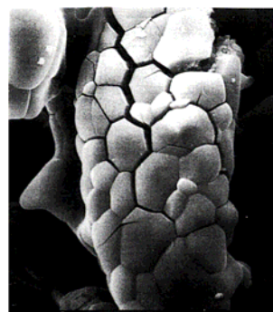
图 2 CaO 与 CO 2 反应生成的 CaCO 3 产物层 Fig. 2 CaCO 3 product layer generated by the reaction of CaO and CO 2
