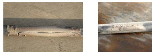
(a) 实验段上排管结渣 (b) 实验段下排管积灰
