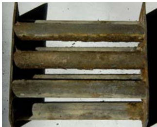
图7 实验段管束布置
