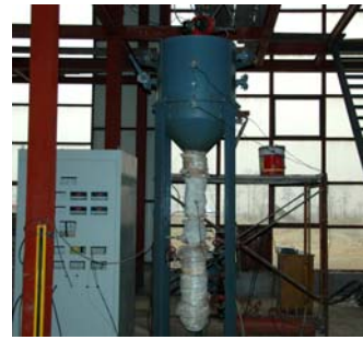
图1 模拟结渣热态实验台
