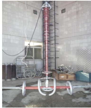
图 22 污闪试验照片
