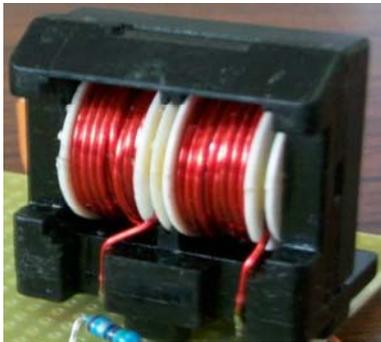
图 3 共模扼流圈照片
