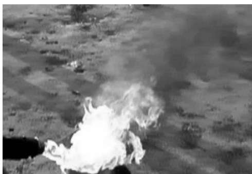
图 3 药柱在喷灯火焰下燃烧
