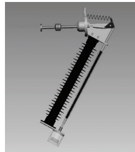
图 4 新型 126 kV 高压真空断路器运动系统机械动态分析 Fig. 4 Mechanical dynamics analysis of the novel 126 kV high voltage vacuum circuit breaker
