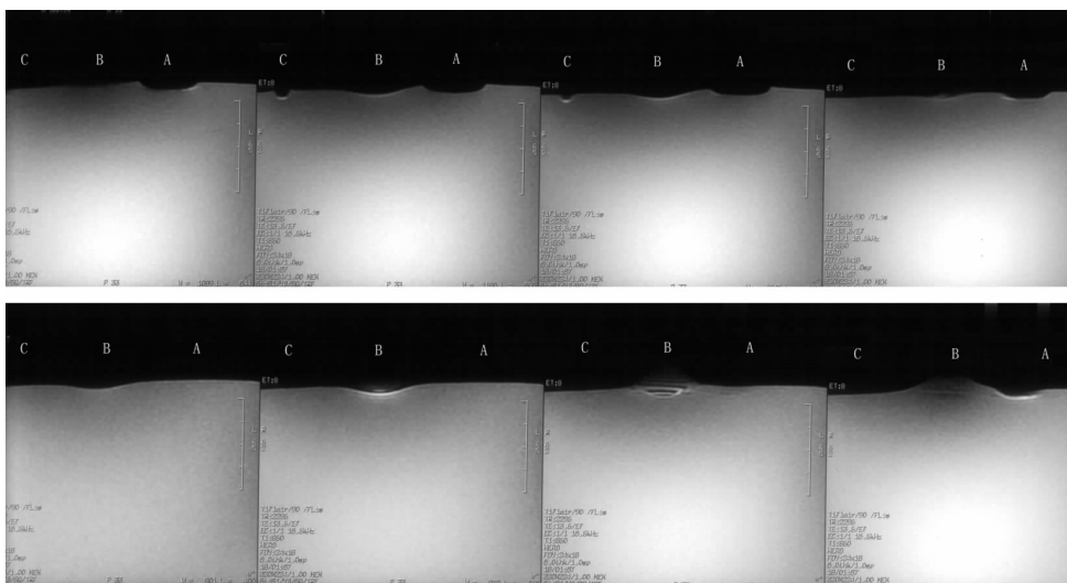
图2 3种烤瓷合金的水模磁共振成像伪影
