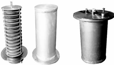
图 2 复合电离室结构
