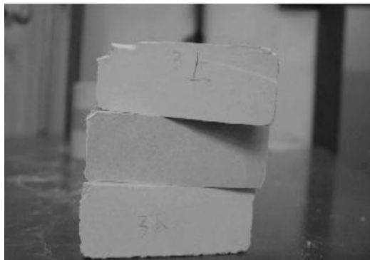
图6 分步压装成型件加工过程中界面分离
