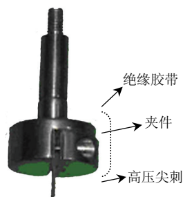
图 7 高压接触不良放电模型
