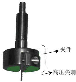
图 6 高压尖刺放电模型
