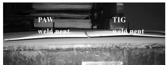
图3 焊接方法对焊件形状的影响
