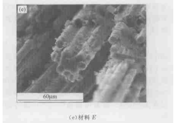
图3 具有不同界面层厚度的 3D-C/SiC 复合材料断口形貌扫描照片
