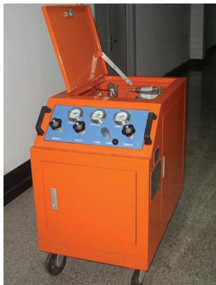
图2 油滤磨屑自动清洗收集装置
