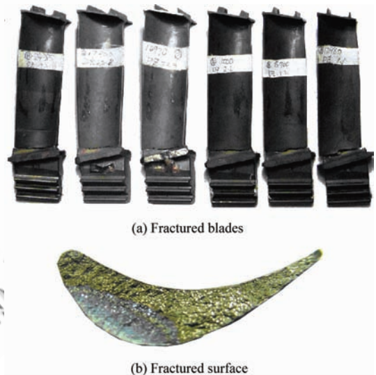
图5 DZ22B合金叶片低周疲劳试验典型断裂特征
