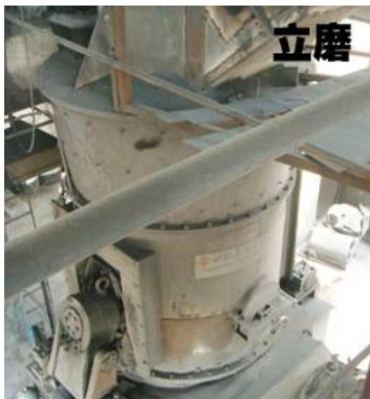
立磨是一种集破碎、干燥、粉磨、分级输送于一体的磨粉设备。立磨广泛应用于水泥、电力、冶金、化工等非金属矿等行业。用于将块状、颗粒状及粉状原料磨成所要求的粉状物料。
