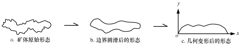
图 8-14 矿体形态的几何变形过程
