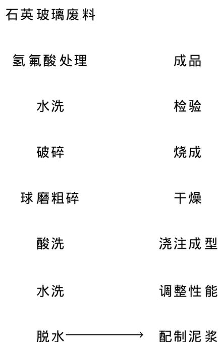
图 5-6 浇注法制造石英玻璃陶瓷的一般工艺流程
