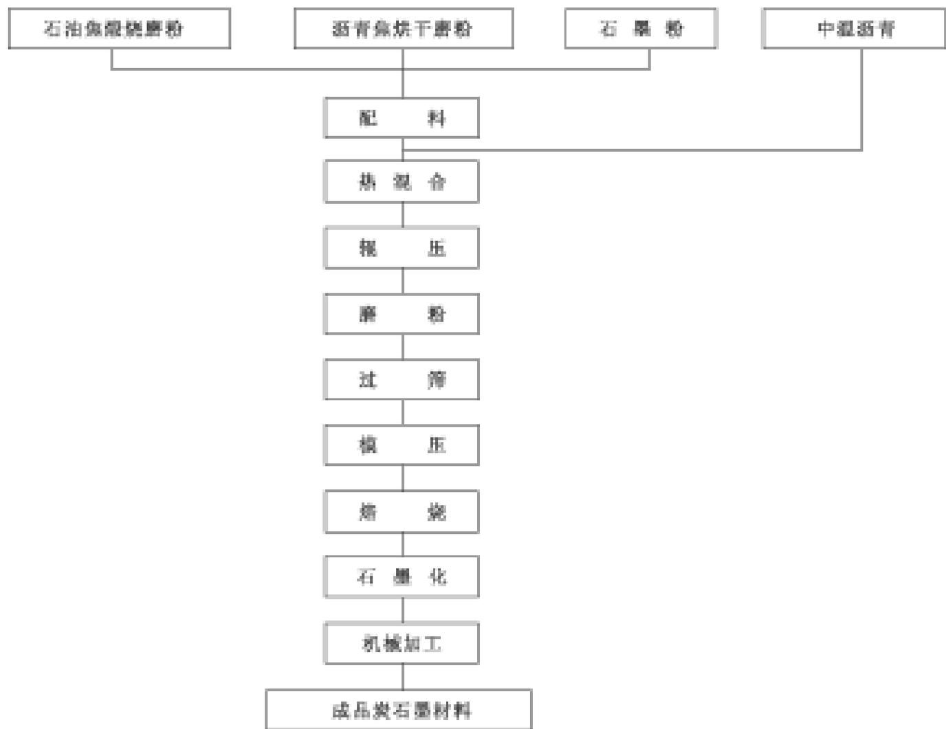
图 9-1 炭石墨基本材料的生产工艺流程图
