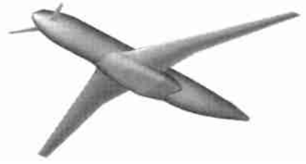
图 1 EuroTSA 项目的鸭翼加主翼的双升力面构型
