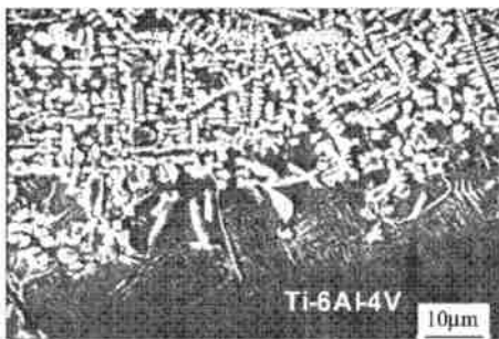
图1 Ti-6Al-4V 钛合金激光气体表面合金化 TiN/Ti“原位”耐磨复合材料表面改性层组织 SEM 照片
