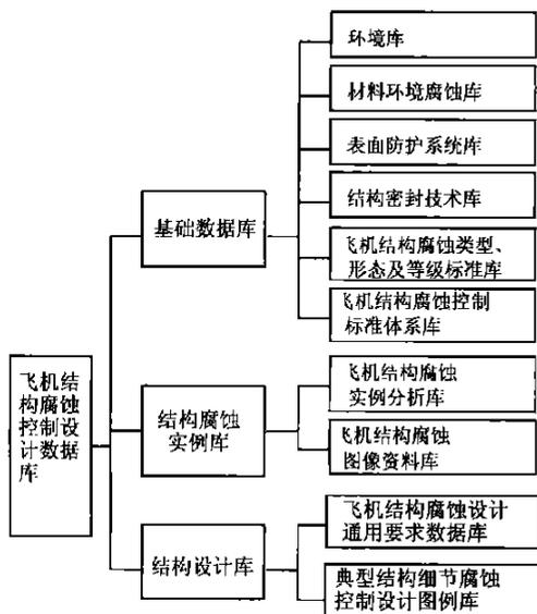
图 1 飞机结构腐蚀控制设计数据库结构基本框图
