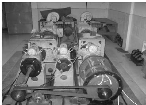
图 2 HIL 双转子电机仿真平台
