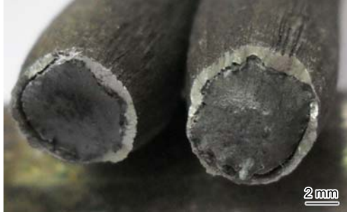
图 6 第 6 道次轧制后包层钢筋的拉伸断口
