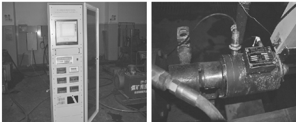
图2 岩石钻进力学测试系统
