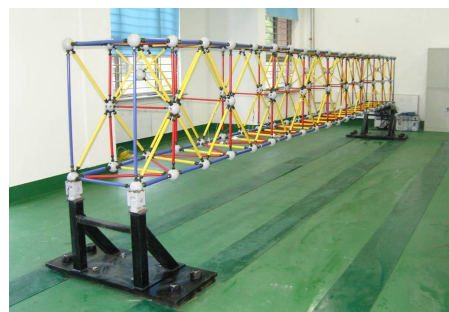
图1 桁架的试验模型
